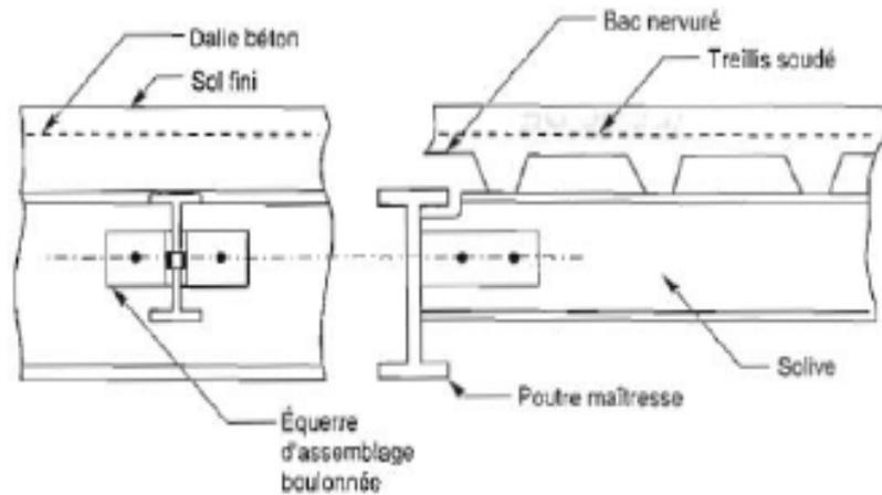
Les planchers mixtes à dalle collaborante étant la solution la plus économique et la plus judicieuse techniquement, nous allons développer la méthode de calculs de ce type de plancher.
