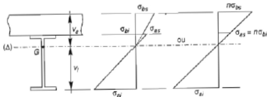
$M$  étant le moment fléchissant maximal dans la section mixte, d'inertie  $I$ , les diverses contraintes extrêmes sont :
