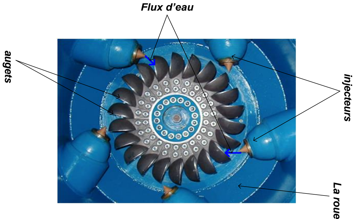
Fig.2. Photo réel de la turbine de Pelton.
