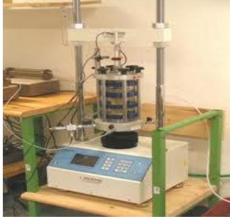
Figure 4.12 Appareillage de l'essai de cisaillement cyclique
