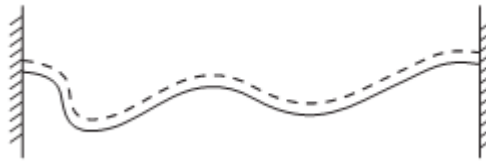
Figure.1.7 Une poutre avec un degré de liberté infini
