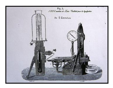
L'appareil de liquéfaction de **Cailletet** est composé des éléments suivants :
