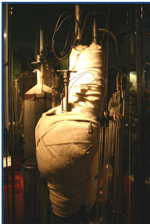
Le liquéfacteur d'hélium utilisé par K. Onnes et son équipe lors de la découverte de la supraconductivité dans le mercure - Museum Boerhaave, Leiden.
