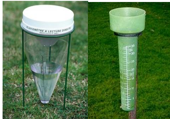
Figure .4. Pluviomètres à lecture directe.
