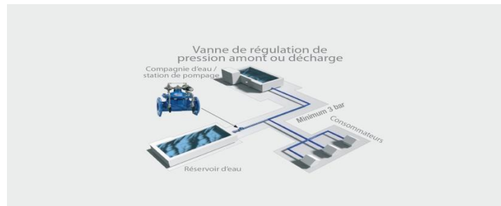
Fig IV.3 : Vanne de régulation de pression amont
