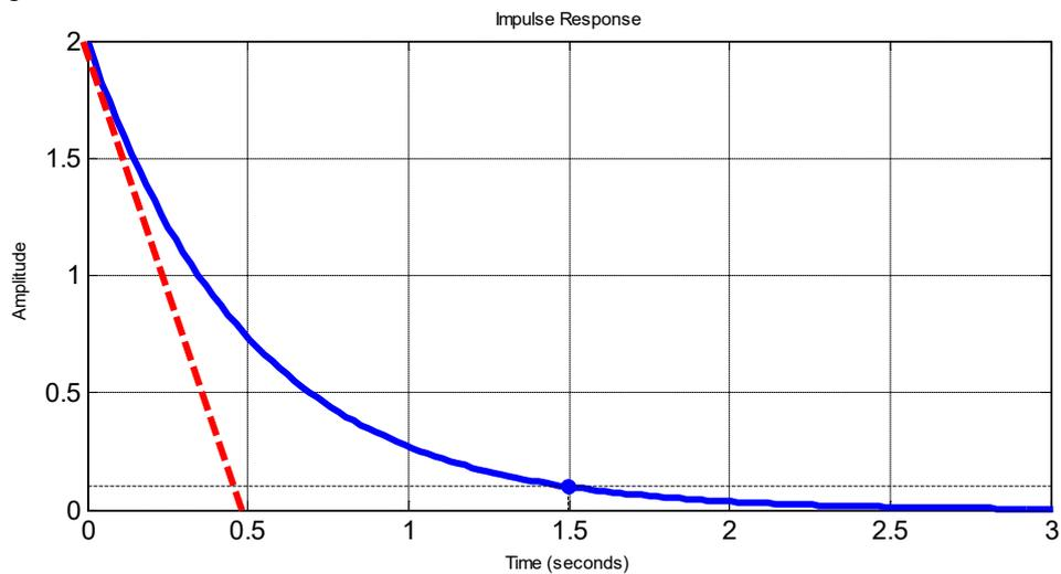
Figure 3.3 Réponse indicielle du système :  $G(p) = 1/(0.5p+1)$
