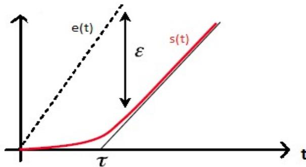
Figure 3.4 Réponse type à une rampe d'un système de 1<sup>er</sup> ordre.
