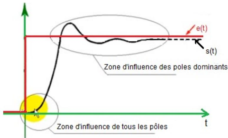
**Figure 3.1** Influences des pôles sur la réponse d'un système
