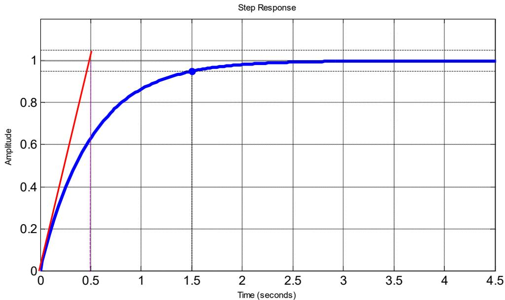
Figure 3.3 Réponse indicielle du système :  $G(p) = 1/(0.5p + 1)$  (où  $t_r = 1.5s$  et  $\tau = 0.5s$ )
