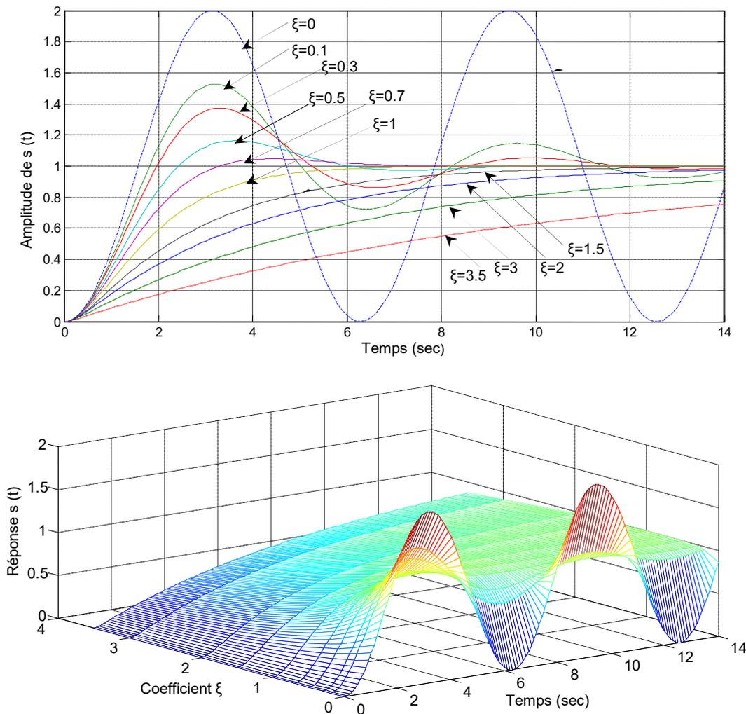
**Figure 3.2** Réponse indicelle du système de second ordre en fonction de  $\xi$  (avec  $k=1$ )
