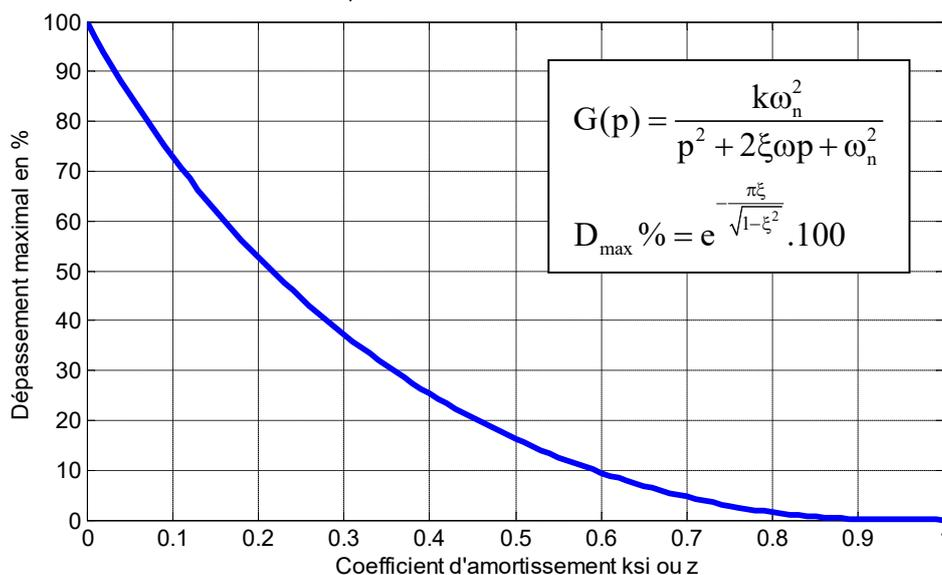
Figure 3.3 Le dépassement maximal (en %) en fonction du coefficient d'amortissement  $\xi$ .
