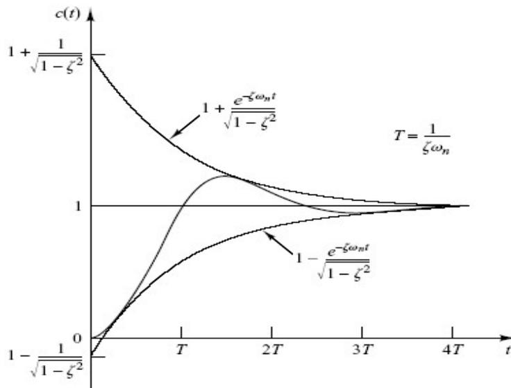
Figure 3.3 Paires des courbes qui enveloppent la réponse indicielle donnée par la figure 3.2 précédente.
