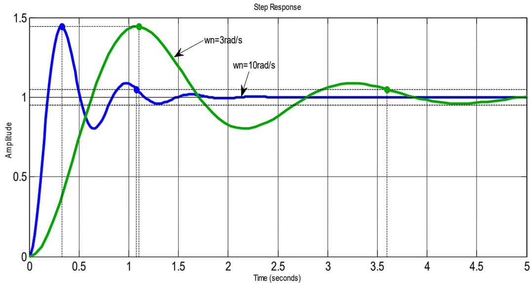
**Figure 3.3** Réponse indicielle du système de l’exemple ci-dessus avec variation de la pulsation  $\omega_n$ .
