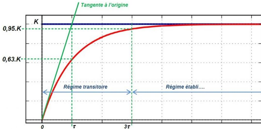
Figure 3.3 Réponse d'un système de 1<sup>er</sup> ordre à une entrée échelon.
