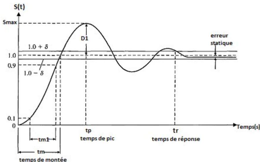
**Figure 3.2.** Réponse indicielle d'un système de second ordre (cas où  $0 < \xi < 1$  et  $k=1$ )
