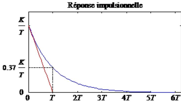
Figure 3.2 Réponse impulsionnelle d'un système de 1<sup>er</sup> ordre
