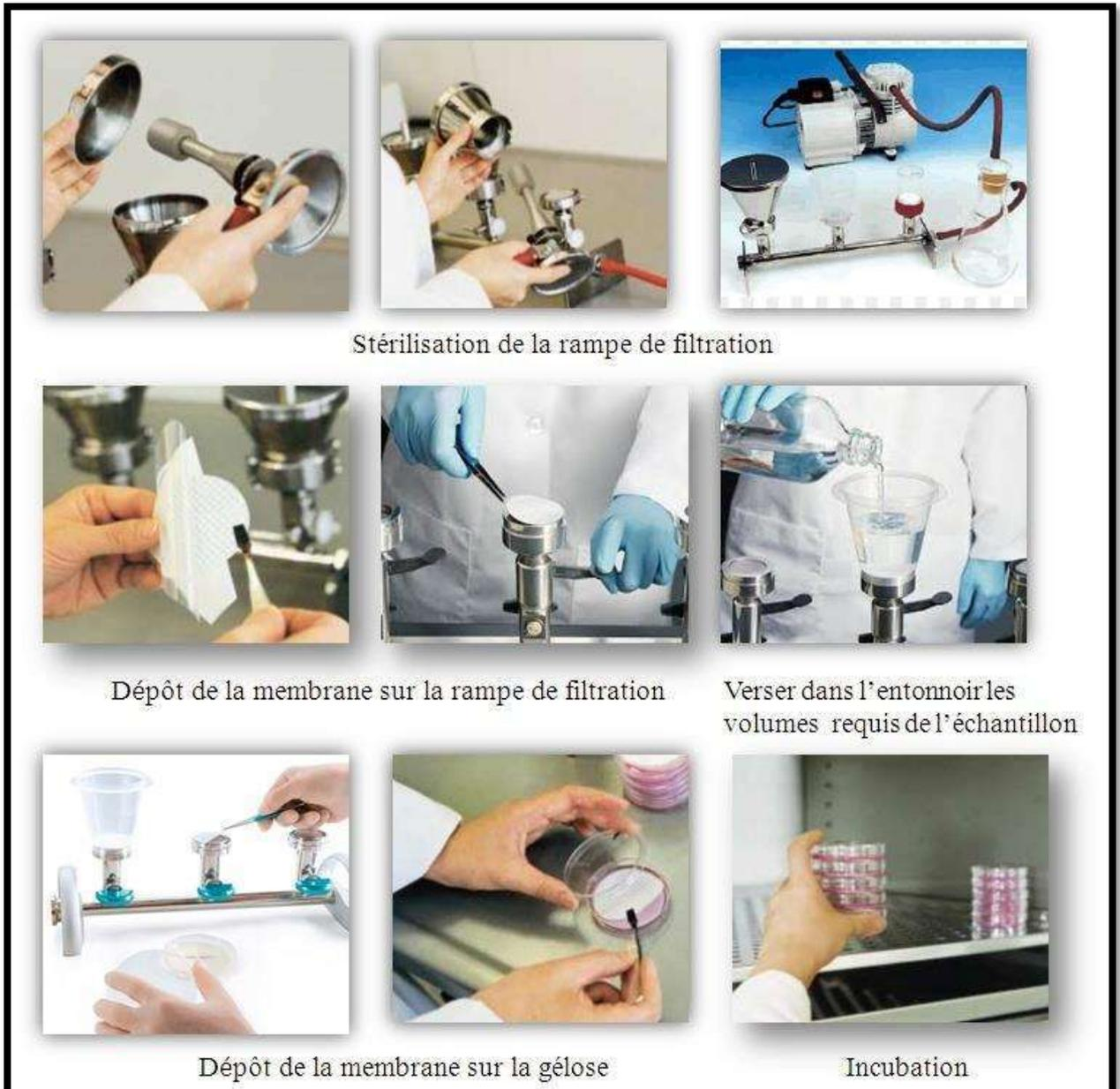
**Figure 24** : schéma explicatif de la technique de filtration sur membrane.
