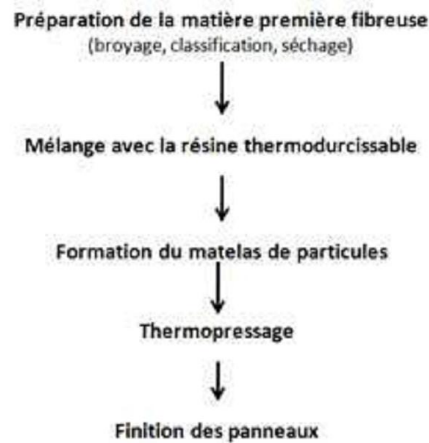
Figure 1.20 : Schéma général de procédé de fabrication de panneaux de particules
