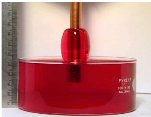
Ascension d'une solution de polyisobutylène le long d'un barreau tournant.
