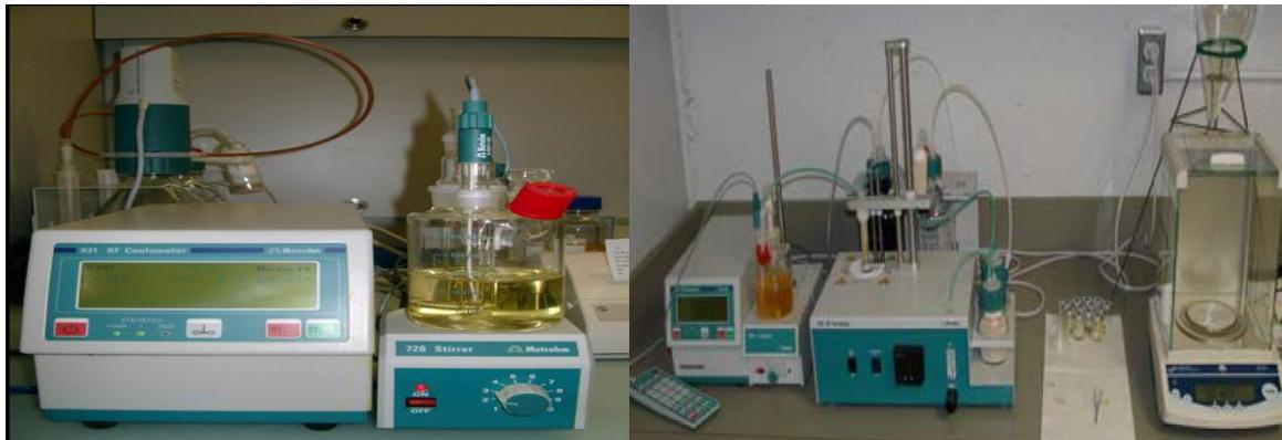
Titreur Coulométrique Karl Fisher pour la mesure de la teneur en eau de liquide isolant.
