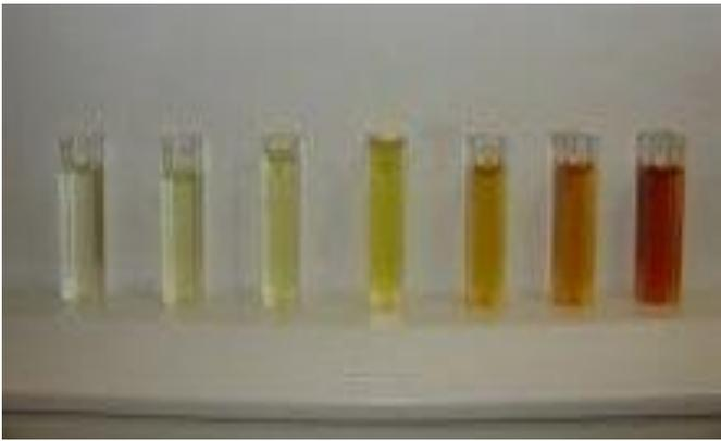
Dégradation de liquide isolant au cours de vieillissement thermique (changement de couleur),
