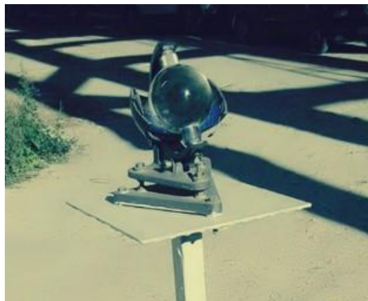
Figure.3 L'héliographe indique le temps d'ensoleillement
