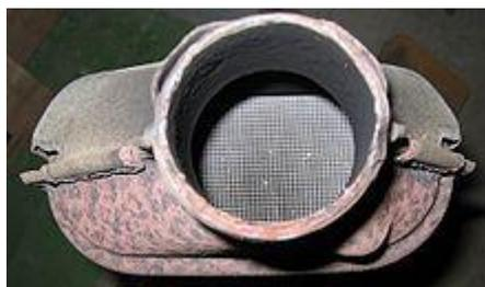
**Figure VI.10.** Schéma vue de la structure interne d'un pot catalytique
