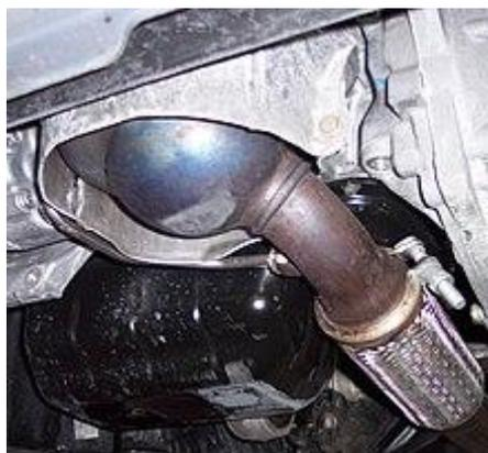
**Figure VI.13.** Filtre à particules installé sur une Peugeot
