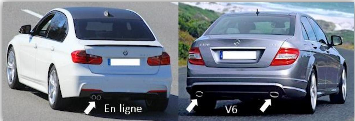
**Figure VI.3.** Doubles sortis d'échappement en ligne & V6
