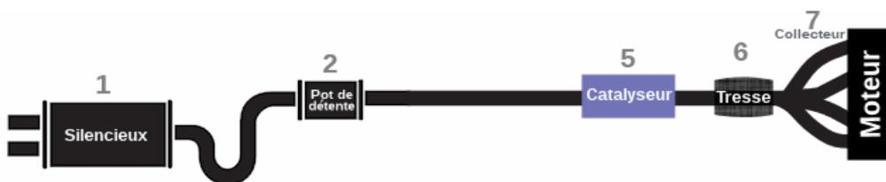
**Figure IV.7.** Schéma de la ligne d'échappement moteur essence
