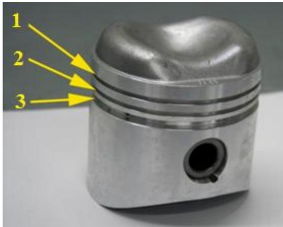
Les ouvertures des segments sont espacées d'un angle pour éviter un passage direct de la pression et de l'huile.
