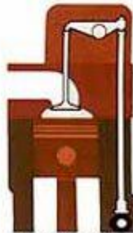
Un arbre avec tiges et culbuteurs
