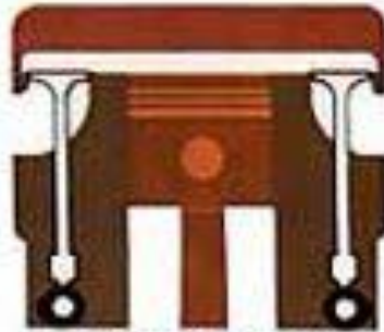
Deux arbres et soupapes latérales
