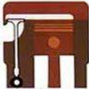
Un arbre et soupapes latérales
