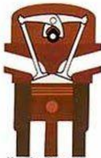
Un arbre à cames en tête et soupapes en V
