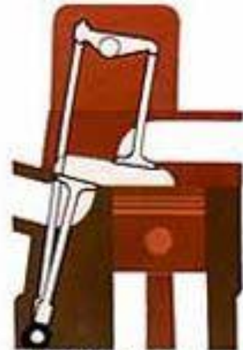
Un arbre avec soup.d'échapp.latérales et admission culbutées
