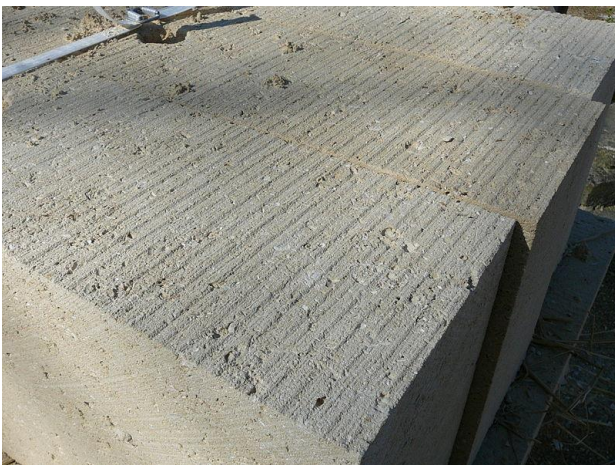
Fig. 7 Blocs de calcaire bruts de sciage de carrière
