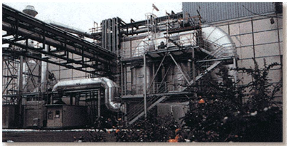
**Figure III.6. Installation d'oxydation thermique régénérative.**
