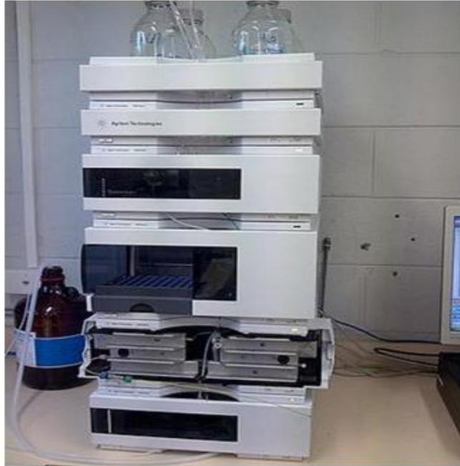
Les composants d'un chromatographe liquide à haute performance
