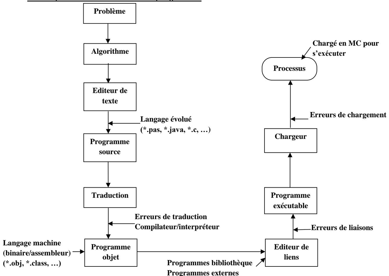
Ces étapes permettent de bien traduire le code source en code machine tout en permettant au programmeur de corriger les erreurs apparues dans chaque étape.
