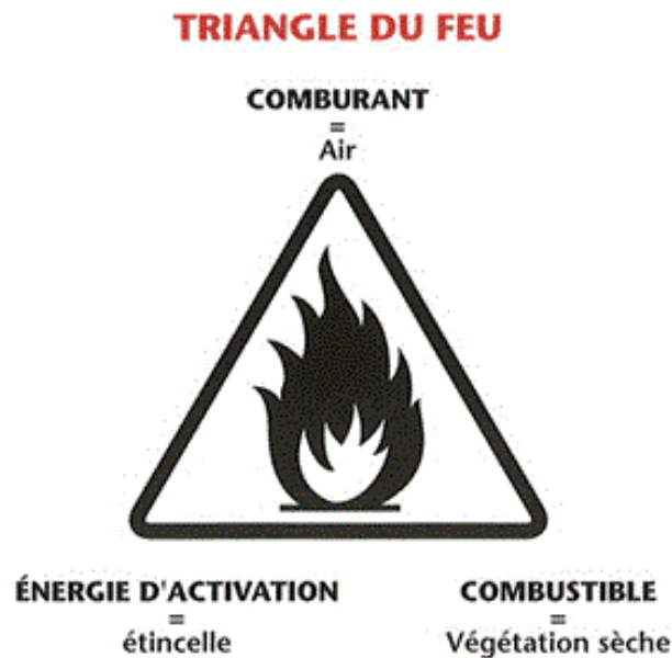
Figure (1) : Les Composantes Du Triangle De Feux
