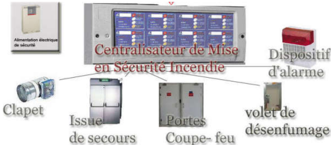
Figure(2) : Système de mise en sécurité incendie
