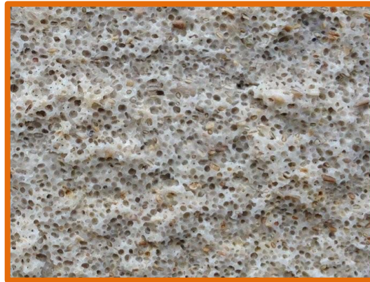
Calcaire à oolites. Le liant ne brille pas du Tout : c'est une matrice. C'est donc une oomicrite. NB : Beaucoup d'oolites ont disparu par dissolution, et on ne voit que leur empreinte.
