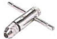
**Le filetage** est une action par enlèvement de matière qui consiste à réaliser des filets sur une tige.
