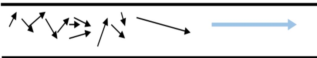
**Figure .V.3. Ecoulement turbulent**
