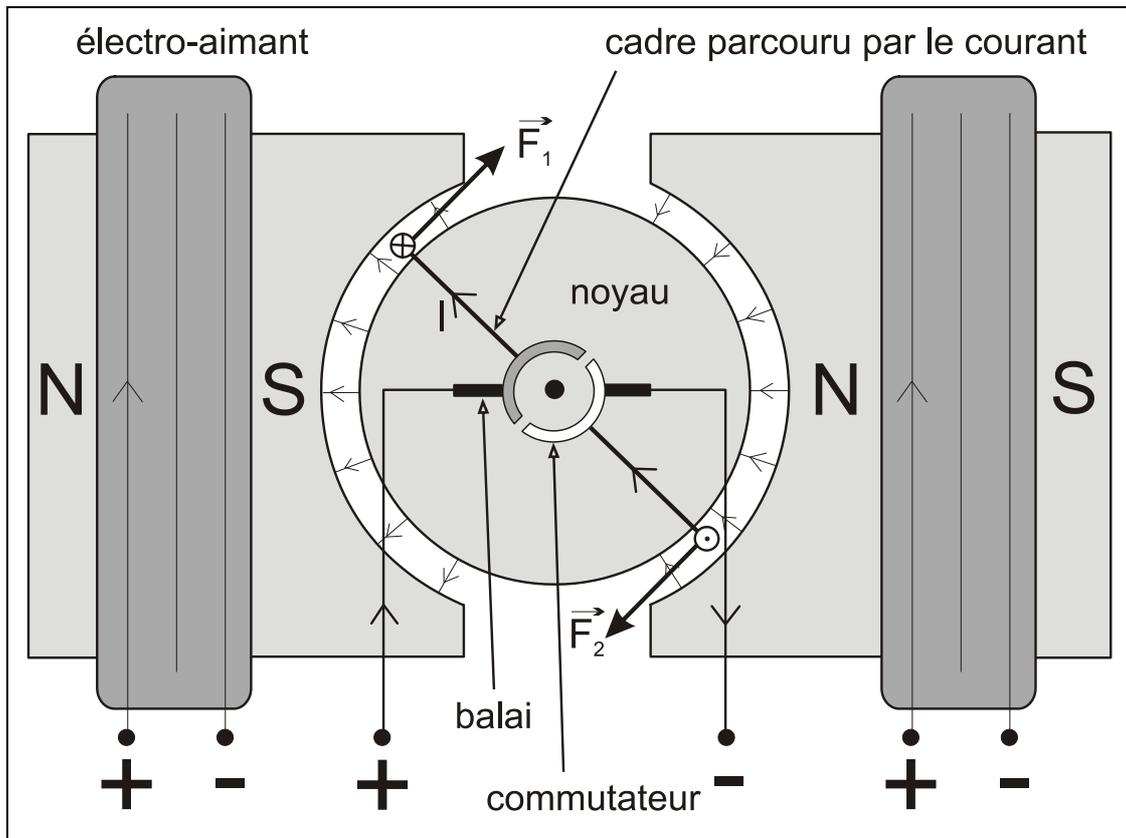
Un **cadre rectangulaire** est enroulé autour d'un noyau de fer cylindrique mobile autour d'un axe fixe. Le cadre est alimenté en courant par l'intermédiaire du **commutateur** : le courant entre et sort par deux balais en graphite fixes qui frottent contre deux demi-cylindres métalliques solidaires du cadre lorsque le moteur tourne ; ces demi-cylindres sont connectés aux extrémités du fil du cadre.
