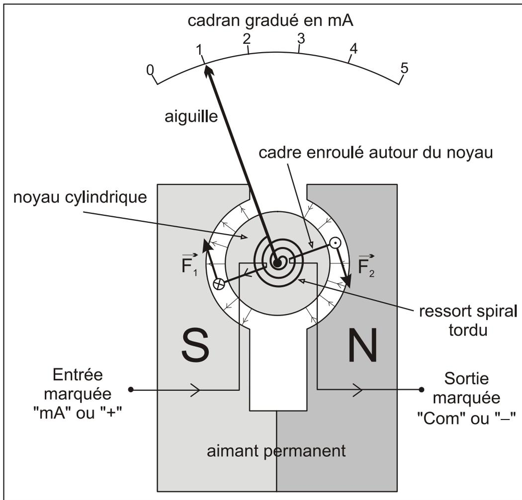
Un **cadre rectangulaire** est enroulé autour d'un **noyau de fer cylindrique** mobile autour d'un axe fixe.
