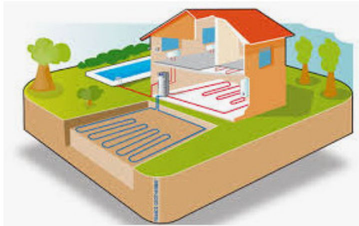
Figure 11. Maison alimentée par l'énergie géothermique
