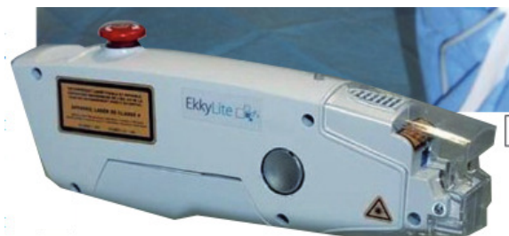
Figure 4. Laser portable développé par la société Ekkyo. Ce laser émet un faisceau de 4 mm x 20 mm.
