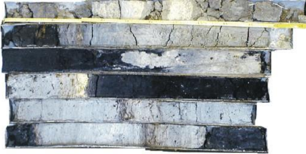
Alternance de dépôts argilo-sableux (gris) et de tourbe (noir) dans un sondage recoupant l'Holocène de la plaine maritime belge. Il s'agit de dépôts de schorre.
